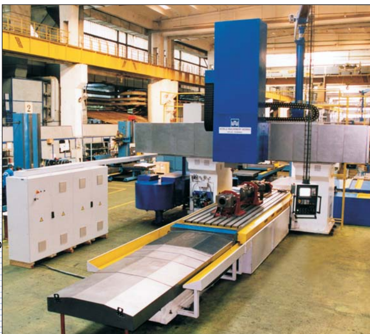
BTM 1600 CNC mașină de frezat tip portal cu schimbător automat cu 30 de scule
