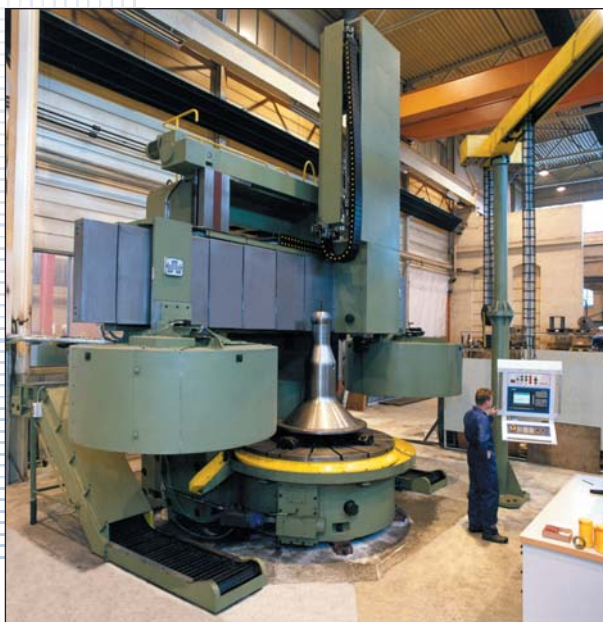
VL 22 CNC strung vertical cu 2 schimbătoare automate de 12 scule pentru frezare și strunjire
