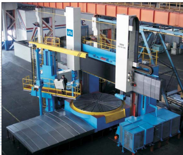
VLO 60 CNC cu 2 culise, două magazine de scule și capete de frezare de înaltă precizie
